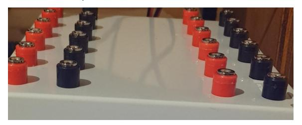
• Una volta installati tutti tagliate 10 spezzoni di cavo rosso e 10 del cavo nero della lunghezza di 5cm, e procediamo a saldare a stagno i cavi sui connettori nel seguente modo rispettando i colori.
