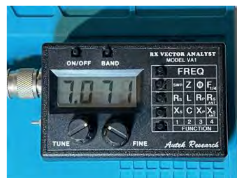
Frequenza alla quale la reattanza è quasi 0 ohm (4 ohm)
