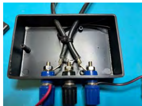
Particolare dell'accessorio autocostruito per la misura passante con NanoVNA; le calze dei due cavi sono collegate fra loro e alla boccia nera, i due poli caldi dei cavi sono collegati alle boccole blu
