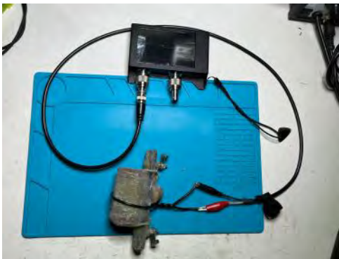
Configurazione per misura reattanza su porta CH0 di un NanoVNA
