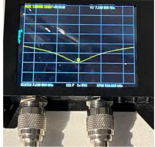
Grafico con centro a 7100 kHz e span di 500 kHz ("spazzolata" da 6850 a 7350 kHz), in cui si vede chiaramente la frequenza di blocco, ovvero la risonanza della trappola, a circa 7100 kHz
