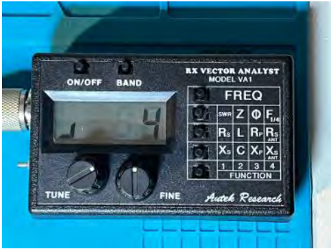
Reattanza di quasi 0 ohm, 4 ohm, alla frequenza di 7071 kHz
