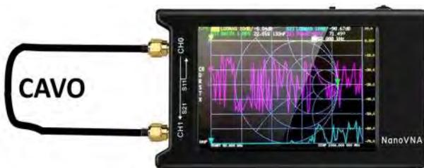
Se dobbiamo lasciare il cavo sul tetto, possiamo misurare l'attenuazione calcolandola come la media del Return Loss S11 su CH0 misurato lasciando aperta l'estremità del cavo sul tetto e del Return Loss misurato cortocircuitando l'estremità del cavo sul tetto, il risultato ottenuto verrà poi diviso per 2, in modo da avere l'attenuazione in un solo verso e non quella di andata e ritorno.
