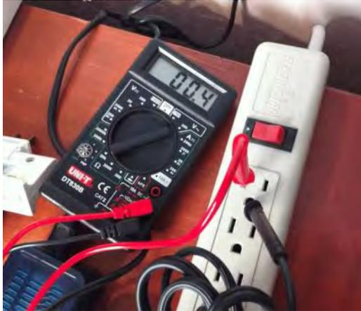
nel terreno ha comunque una capacità verso terra sufficientemente alta, oppure vengono captati dei disturbi di sufficiente ampiezza.
