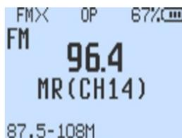
*Durante la ricezione della trasmissione il VFO attivo ha ancora la priorità. Ciò significa che qualsiasi ricezione sul VFO attivo disabiliterà temporaneamente la ricezione delle trasmissioni e la radio passerà alla ricezione VFO. Al termine della ricezione VFO la radio torna alla trasmissione.*
