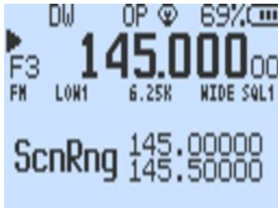
*ScnRng* la funzione è supportata anche dall'analizzatore di spettro. Se hai attivato la funzione, avvia semplicemente l'analizzatore di spettro.
