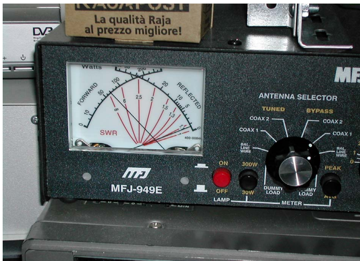
LETTURA DEL R.O.S. Sui 24940 KHz DOPO LA TARATURA
