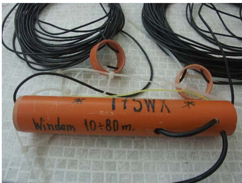
Figura 5 – Vista del contenitore Balun ed isolatori terminali.
