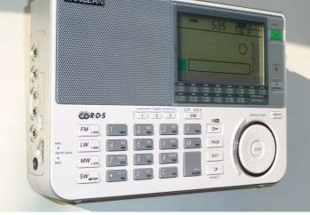
manopola laterale per la sintonia, bensì un sistema jog-shuttle o rotary tuning knob che ricorda molto quello del ricevitore Sony SW-77, corredato di due appendici eccentriche con i comandi tuning up e tuning down e di un bottone concentrico per cambiare il passo di sintonia (da veloce a lento e viceversa). È decisamente simpatico e assolutamente comodo da usare.
